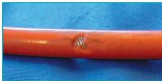
поврежденные шланги не использовать
